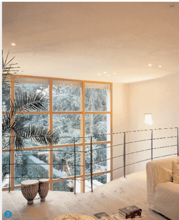
3 Licht stroomt rijkelijk binnen via een ruim 5 meter hoge raampartij met een groot warmte-isulerend vermogen (1,3 W/m 2 K, zonnefactor 67%).
