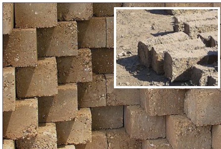
Leemblokken kunnen vanuit de diverse aggregatietoestanden gefabriceerd worden. Niet-plastisch leem wordt in blokken geperst en vloeibaar leem kan gebruikt worden om vermengd te worden met plantaardige vezels (zoals hennep - inzet)
